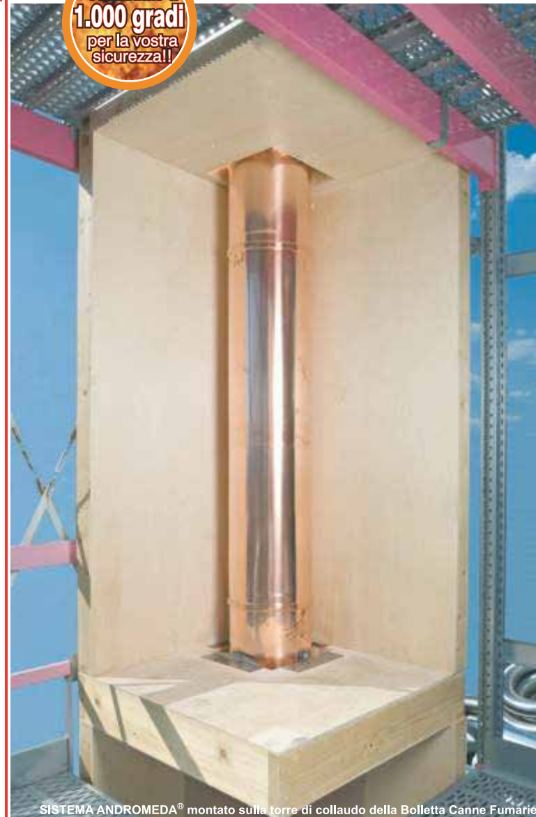
SISTEMA ANDROMEDA® montato sulla torre di collaudo della Bolletta Canne Fumarie
